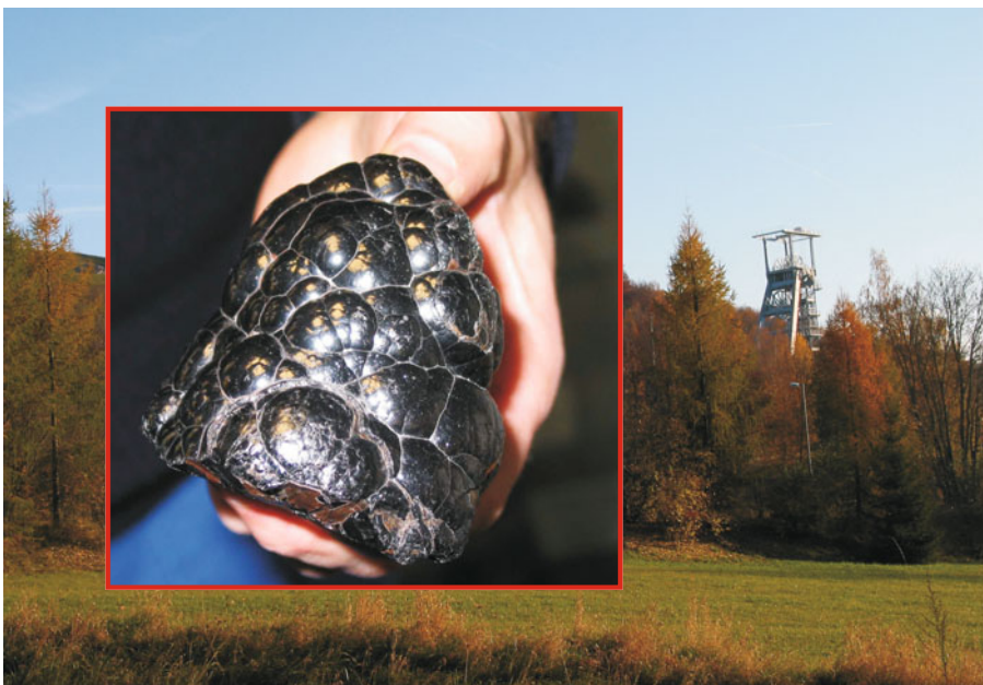
Abb. 12.4 Der Schacht 371 war Hauptschacht der SDAG Wismut im Auer Revier und führte bis in 1800 m Teufe. Das Objekt der Begierde hieß Pechblende, reines \text{UO}_2 (Handstück: Sammlung Wismut GmbH).
